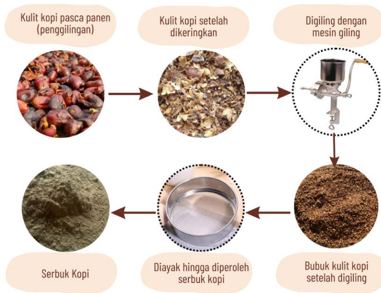
Gambar 3. Alur pembuatan tepung kulit kopi
