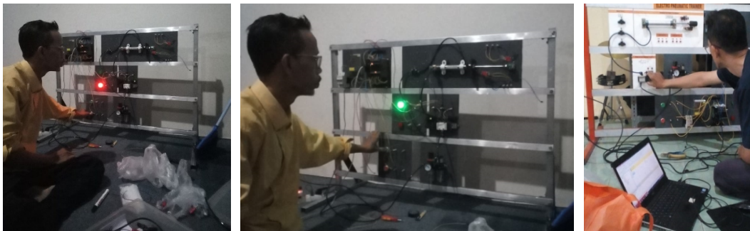
Gambar 3. Pengembangan dan uji coba alat peraga otomasi pneumatik berbasis PLC.
