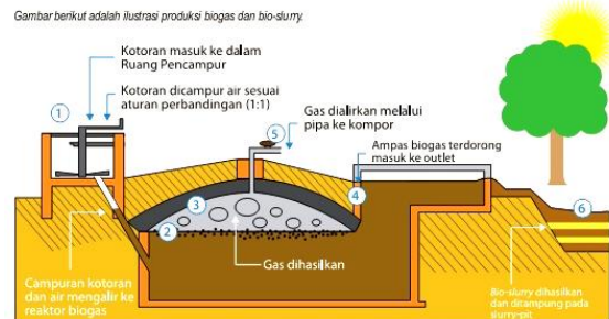
Gambar 3. Instalasi produksi biogas dan bio-slurry Sumber : Biogas Rumah (PT.Biru Hivos-Lombok-Bali)
