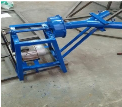
Gambar 3. Mesin penyedot debu yang sudah dirangkai dengan rumah keong
