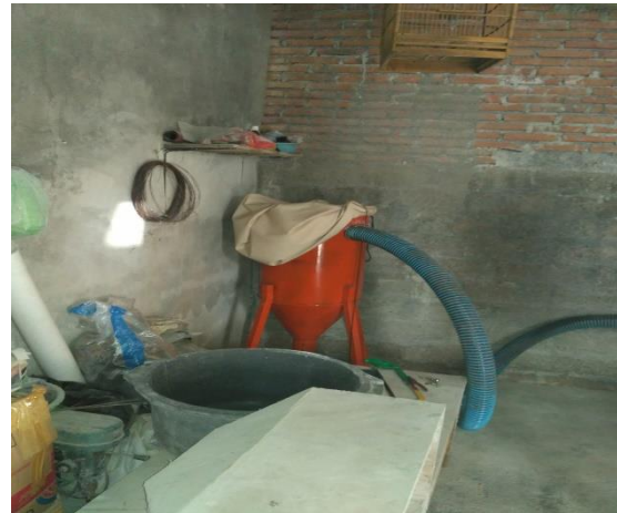
Gambar 4. Alat penampung debu berbentuk silo
