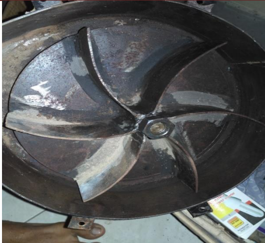
Gambar 2. Impeler / Sudu penyedot debu berbentuk kipas
