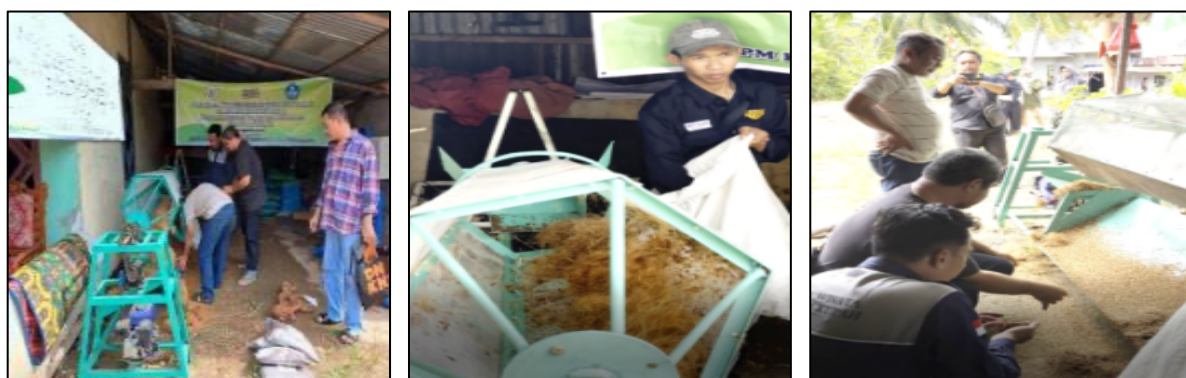
Gambar 5. Penerapan Mesin Pengayak Serabut Kelapa Bersama Mitra
