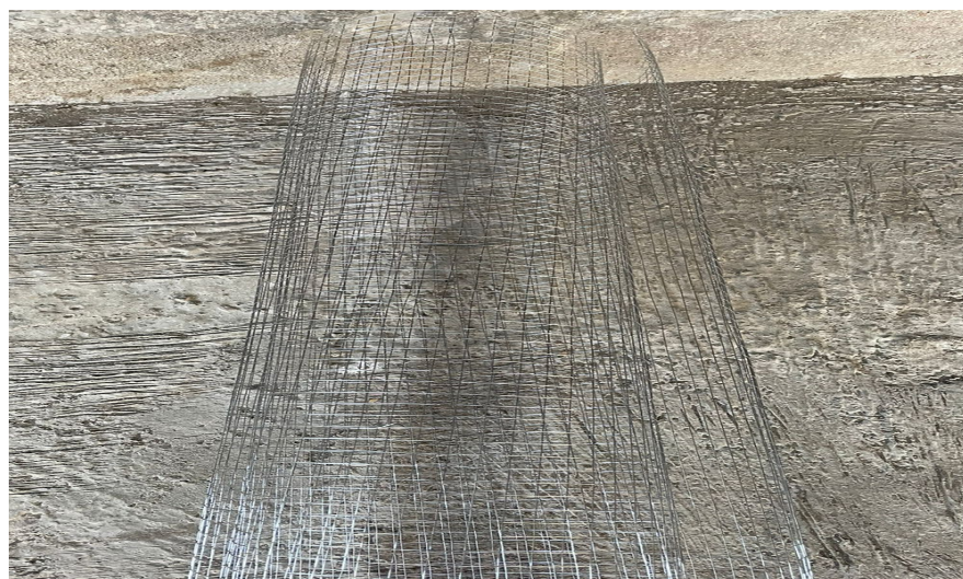
Gambar 3. Kawat Anyam Dengan Diameter Lebih Kurang 1 Milimeter Sebagai Bahan Utama Dalam Penerapan Teknologi Ferosemen
